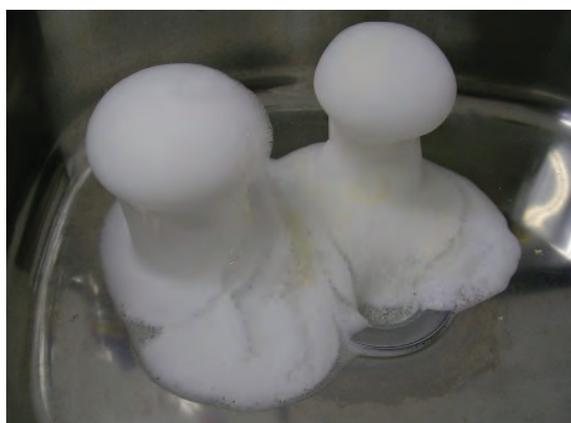
Figura 2. Fermento biológico com água oxigenada
