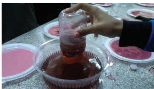
Figura 7. Sistema colocado inversamente demonstrando a forte tensão superficial da água
